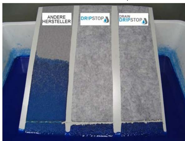
*Alle Proben wurden 24 Stunden bei einer Neigung von 20° getestet.*
